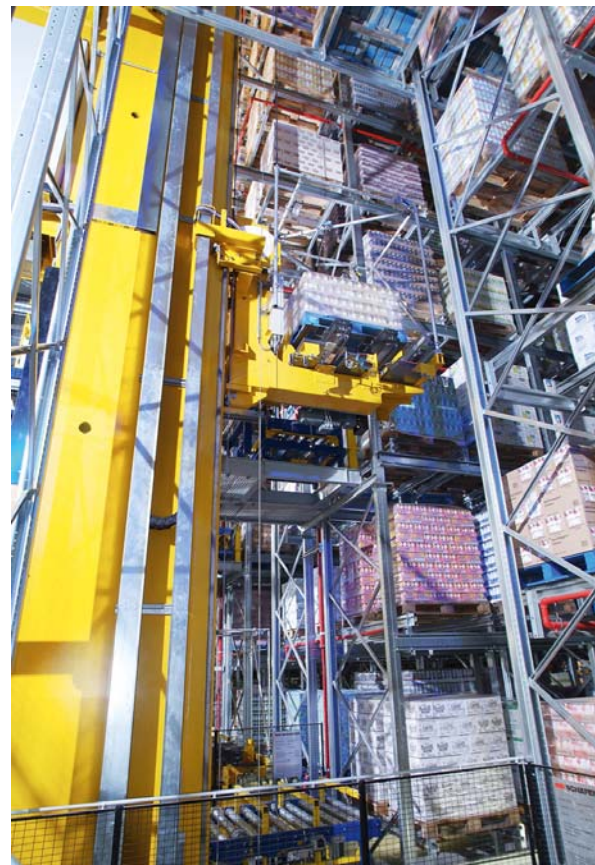
Abbildung 2: Regalbediengerät im Hochregallager
